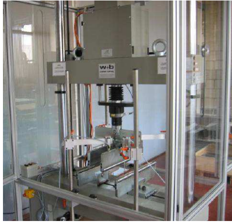
Figure 32 – Presse utilisée pour l'essai de résistance à la flexion sur plaque mince
