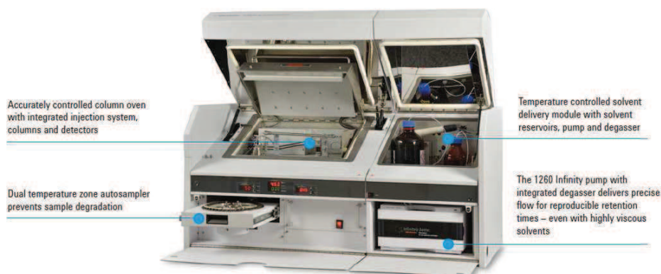
Figure 12 : Appareillage PL-GPC200
