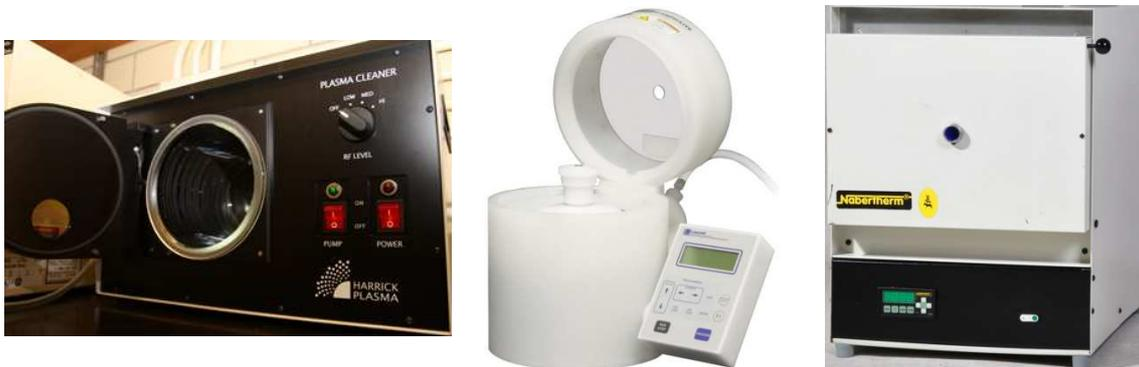
**Figure II-28.** De gauche à droite, photos du Plasma Cleaner, du Spin-coater et du four métallurgique employés lors de l'élaboration des échantillons.
