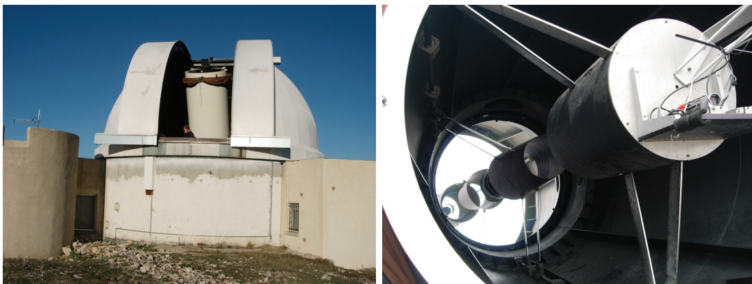
Figure 5.1 – Vue du télescope MeO et de ses miroirs primaire et secondaire.
