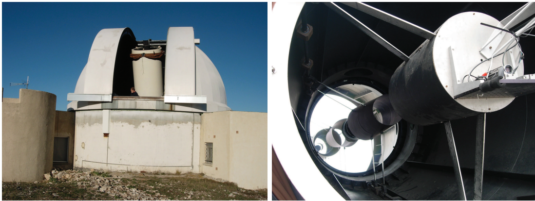
Figure 5.1 – Vue du télescope MeO et de ses miroirs primaire et secondaire.
