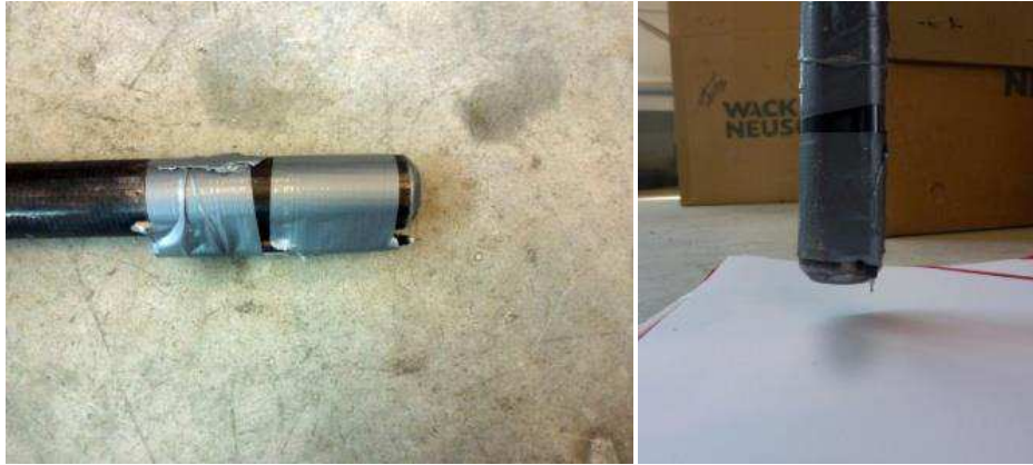
Figure 4.13. Dispositif de mesure de l'amplitude maximale d'une aiguille vibrante dans l'air. IREN38.
