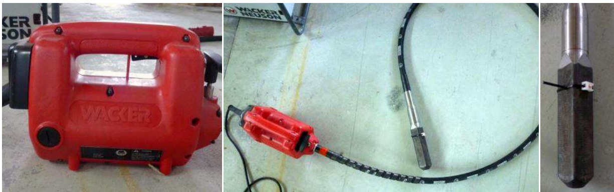
Figure 4.36. Moteur électrique M 3000 (gauche). Moteur + aiguille vibrante H45 (milieu). Tête d'aiguille vibrante H45 (droite).
