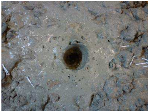
Figure 4.25. Trou laissé après vibration par IREN 38 plongée dans S2TV avec une fréquence rotation égale à 35 Hz.
