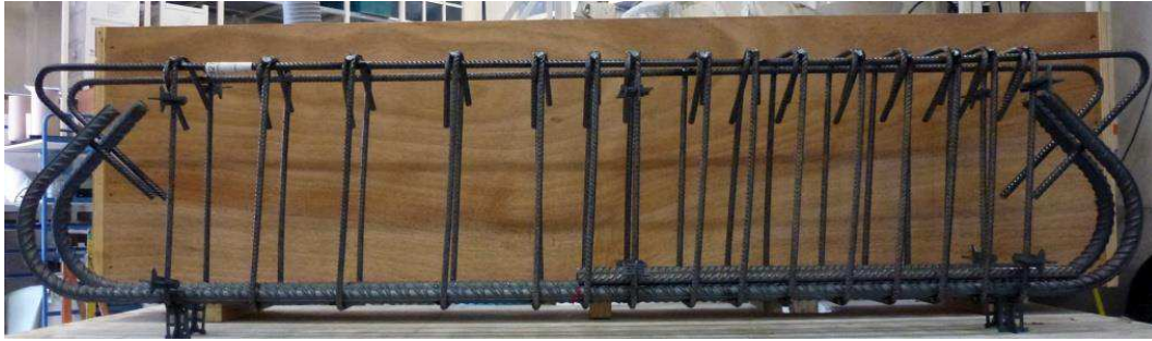
Figure 4.39. Cage d'armature pour l'étude du rayon d'action dans une configuration de type poutre. Ferrailage lâche à gauche et dense à droite.
