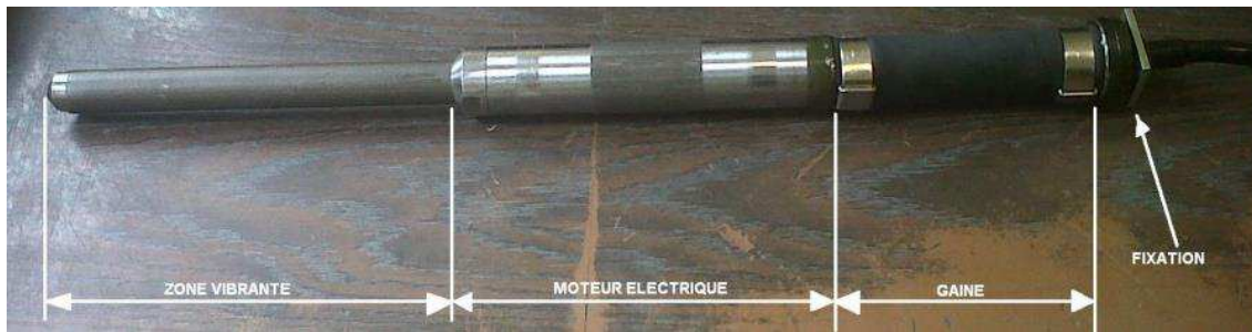
Figure 4.7. Aiguille vibrante de 25 mm de diamètre connectée au système de variateur de fréquence.
