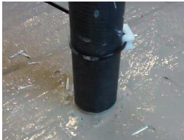
Figure 4.30. Dispositif de mesure de l'amplitude et de la fréquence d'une aiguille vibrante.
