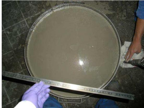
Figure 4.10. Mesures du diamètre d'action.
