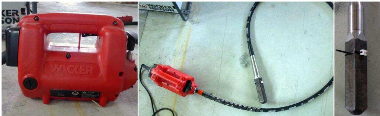
Figure 4.36. Moteur électrique M 3000 (gauche). Moteur + aiguille vibrante H45 (milieu). Tête d'aiguille vibrante H45 (droite).
