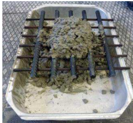
Figure 4.40. Cage d'armature témoin pour l'étude de la formation d'une voûte granulaire. Béton de consistance S3.
