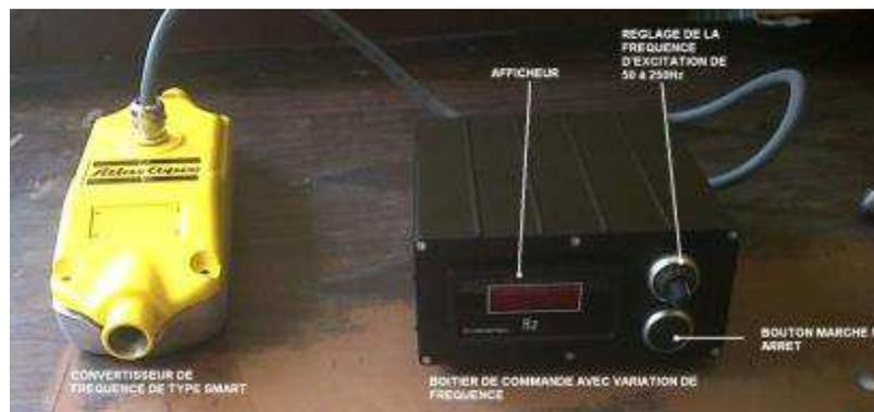
Figure 4.6. Système de variateur de fréquence.
