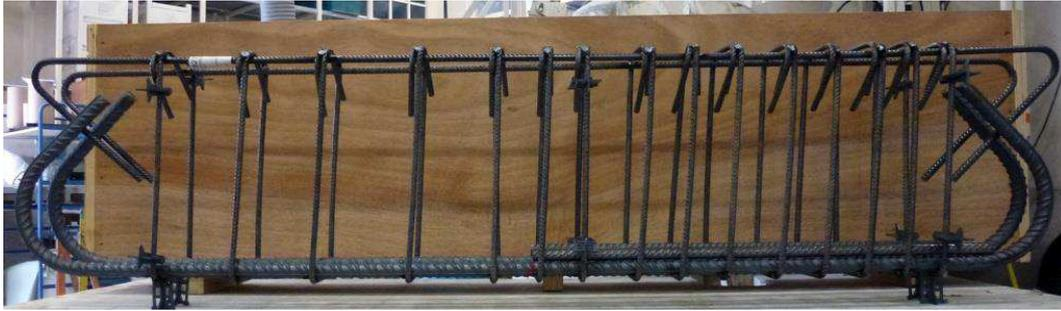
Figure 4.39. Cage d'armature pour l'étude du rayon d'action dans une configuration de type poutre. Ferrailage lâche à gauche et dense à droite.
