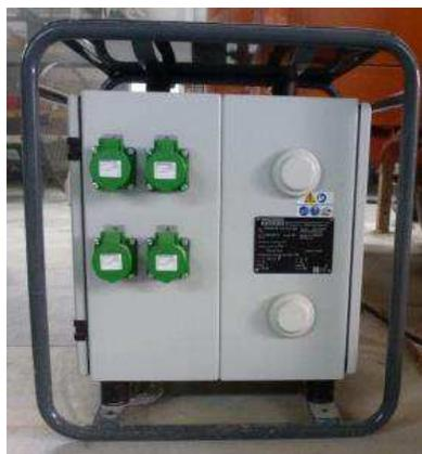
Figure 4.9. Convertisseur à fréquence variable FUE-M/S 85A.
