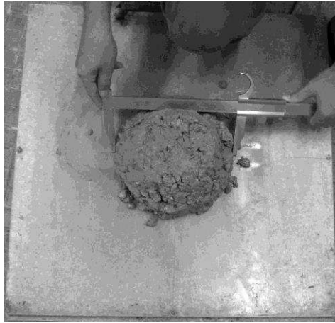
Figure 3.7. Mesure du diamètre de béton à la fin de l'essai d'étalement à la table à choc.
