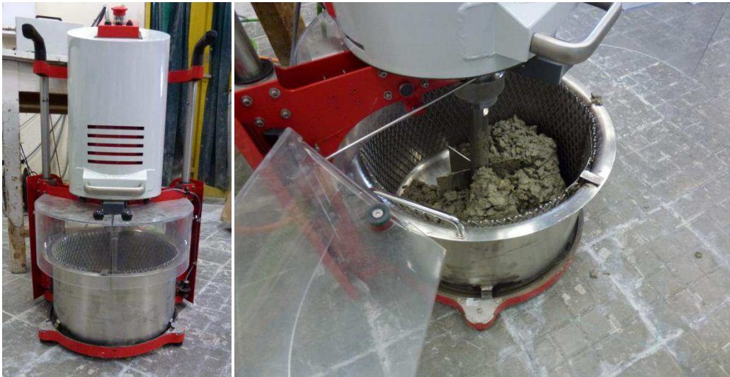
Figure 3.5. Vue générale du BTRHEOM II (gauche). Cuve en cours de remplissage (droite).
