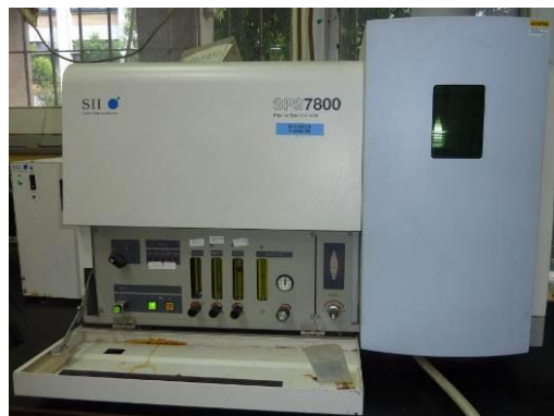
Figure II-5 : L'appareil d'ICP-AES d'un système SPS-7800 de Seiko Instruments Inc.
