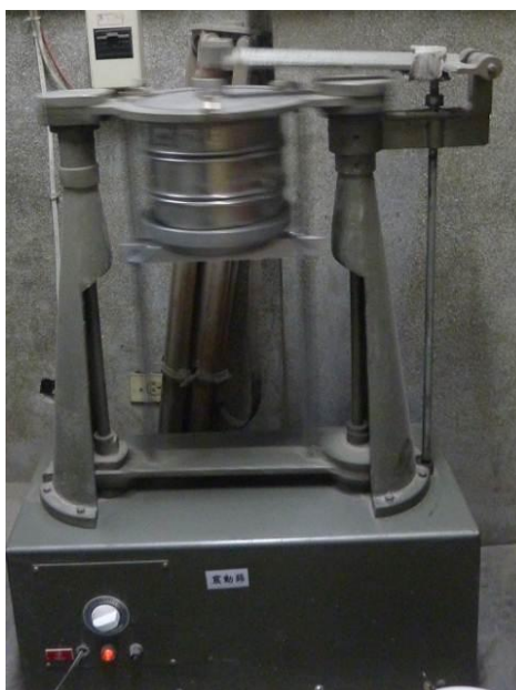
Figure II-2 : Séparateur à vibration de Sweco
