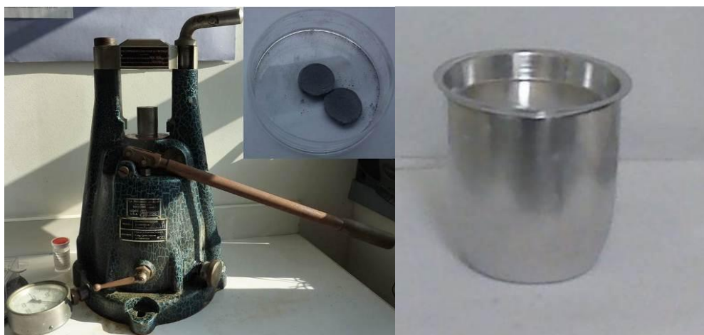
Figure II-1 : a- Presse manuelle; b- Creuset avec couvercle spécial anti-volatilisation (Socachim)
