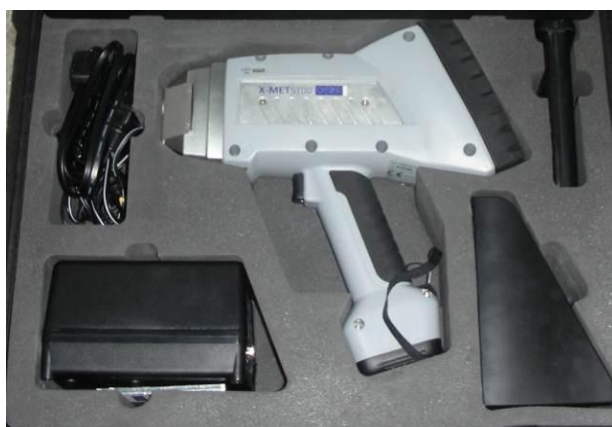
Figure II-6 : La spectrométrie de fluorescence X-MET5100
