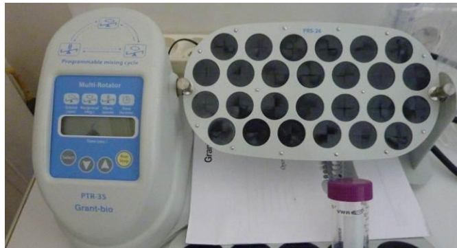
Figure II-4 : Mélangeur rotatif PTR-35 GRANT-BIO pour procéder le test TCLP
