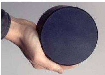
Figure 6 : Photo d'un bloc de SYNROC (document accessible sur le site www.eoearth.org/article/Synroc , dans l'article de Ian Hore-Lacy [16].
