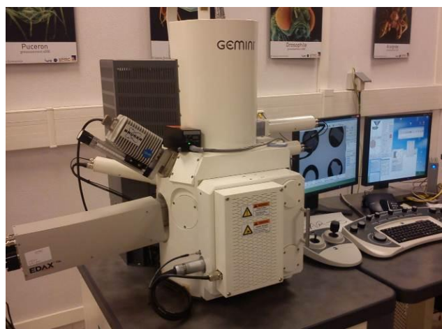
Figure II-9 : Microscope à balayage avec analyse en dispersion d'énergie des rayons X
