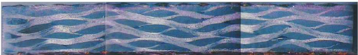
Figure I. 19 - Section longitudinale macroscopique du Tisseur 3. [1]
