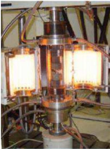
**Figure III-3 : Dispositif de compression uniaxiale à chaud.**
