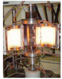
Figure III-3 : Dispositif de compression uniaxiale à chaud.
