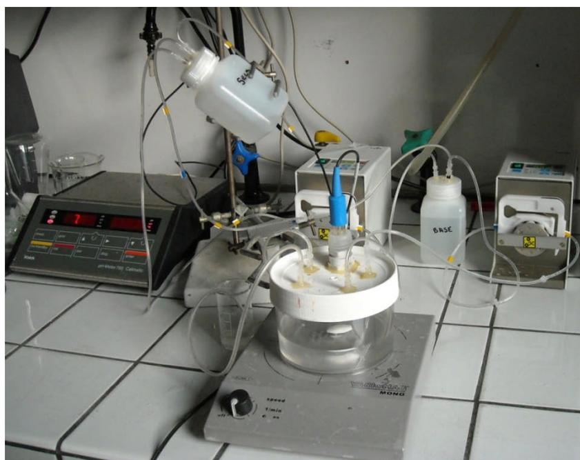
Figure 2.3 : Dispositif expérimental utilisé pour la synthèse des composés HDL.
