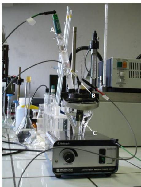
Figure 3.44 : Cellule électrochimique reliée par des fils au potentiostat : (A) électrode de référence, (B) électrode auxiliaire et (C) électrode de travail (1cm<sup>2</sup>).
