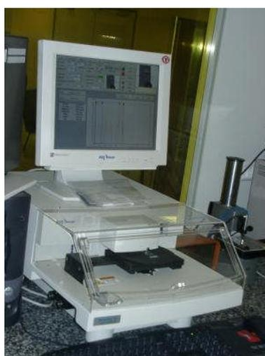
Figure 3.41 : Profilomètre de type Alpha-step IQ surface profiler (KLA TENCOR).
