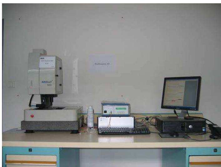
Figure II.7. Profilomètre 3D ALTIMENT X AltiSurf 500
