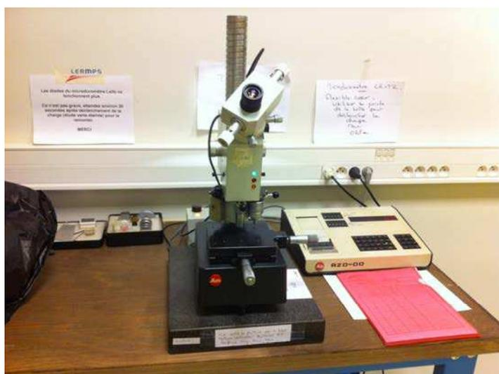
Figure II.8. Photo du duromètre Vickers Leitz, Allemagne
