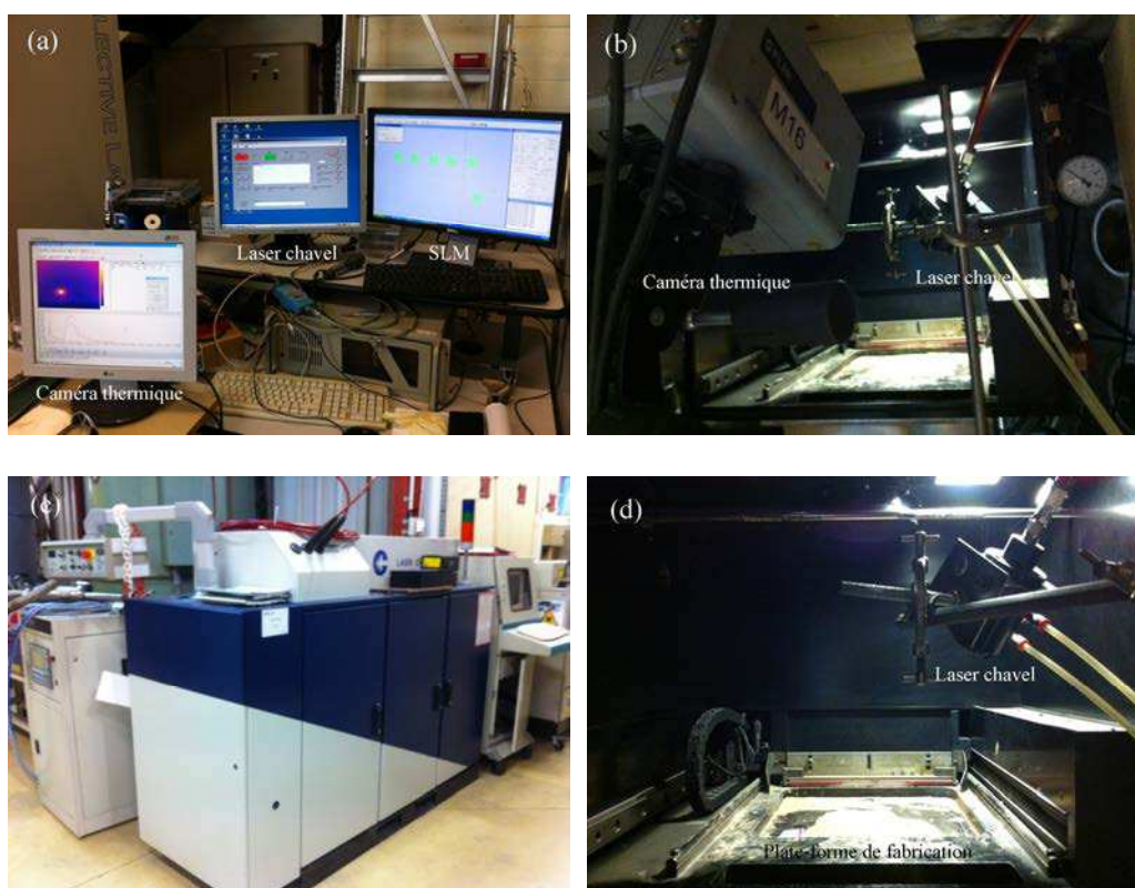
Figure IV.2. Processus de préchauffage par laser Nd-YAG CHEVAL de grande puissance, (a) l'unité de commande, (b) et (d) l'atelier de fabrication, (c) laser Nd-YAG CHEVAL
