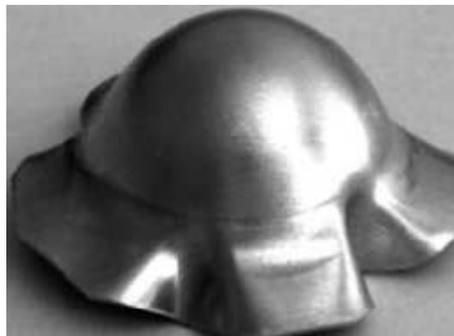
FIGURE 2.27 – Plissement en emboutissage sans serre flan
