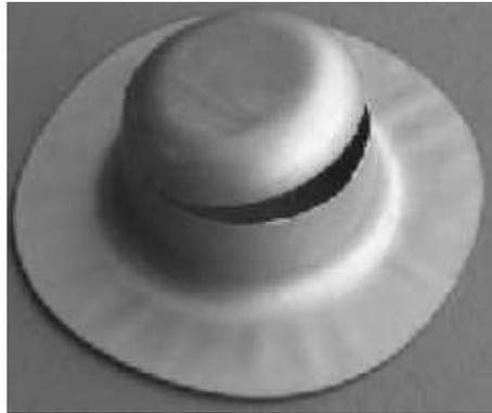
FIGURE 2.26 – Rupture d'une pièce au cours d'emboutissage
