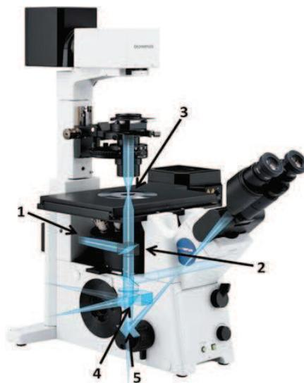
**Figure II.6** : Photographie du microscope inversé Olympus IX 71 et représentation schématique du système optique [9].
