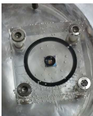
Figure 4-24 : Photo d'une puce en fin de gravure dans la cellule de protection en plexiglas.
