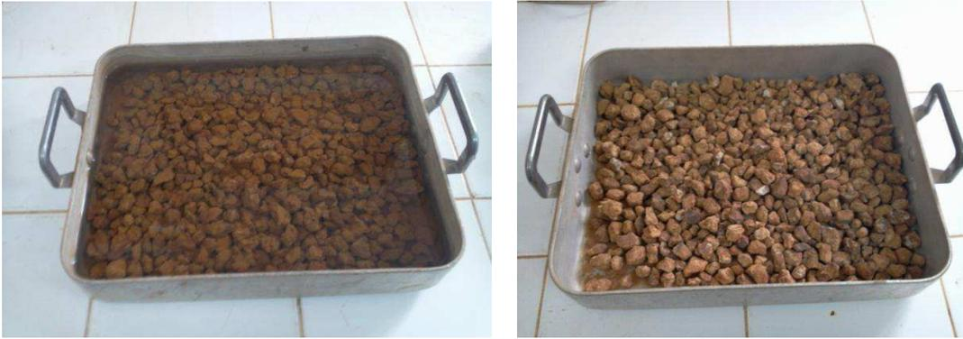
**Figure 2.9.** Étude de la durabilité de la fraction 10/20 mm de la latérite de Lam-Lam : essai de dégradabilité
