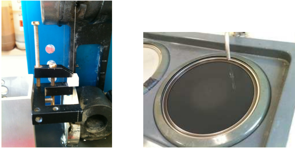
FIGURE 5.3 – Équipements du laboratoire LMS utilisés (1) pour découper l'échantillon (figure gauche) et (2) pour polir les faces de l'échantillon (figure droite).
