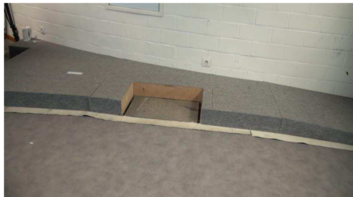
Figure III.8: Le trottoir amovible formé de différents 'caissons', ainsi que les 2 PFF respectivement dans le trottoir et dans la chaussée recouverte de linoléum.
