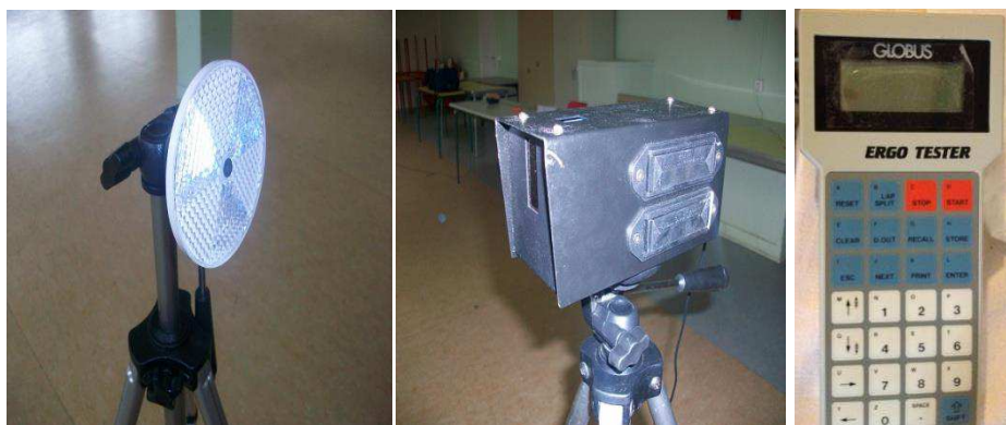
Figure II.3. Photographie du chronomètre Globus muni d'une cellule réfléchissante (à gauche), du boîtier d'émission du faisceau (au centre) et du boîtier de calcul et de commande (à droite).
