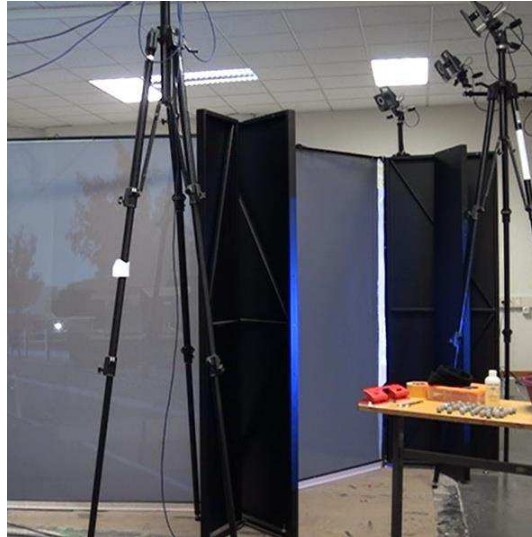
Figure III.14. Vue arrière des écrans montrant les caches permettant d'éviter qu'une image ne se superpose à l'image voisine.
