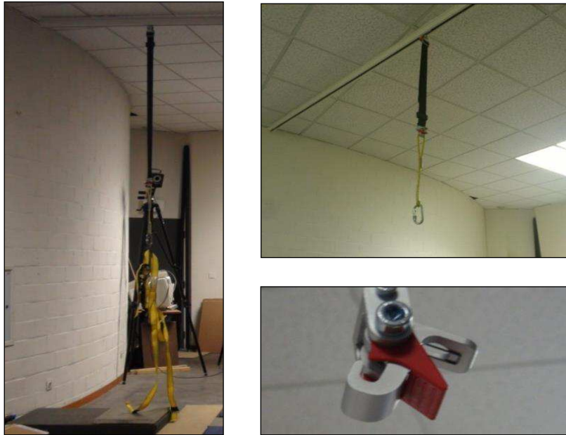
Figure III.9. Le système de sécurisation du participant. A gauche : harnais attaché au système de suspension. A droite en haut : rail et sangle. A droite en bas : crochet de fixation du harnais à la sangle.
