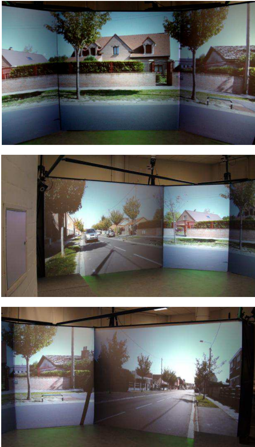
Figure III.17. Rendu visuel du simulateur, vue de gauche (haut), de face (milieu) et de droite (bas).
