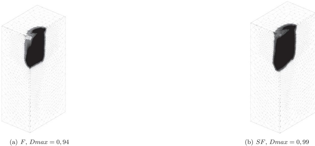
Figure 11.28 – Cartographie de l’endommagement pour  $PO1\_300$ , à la charge de ruine ( $134\text{ kN}$  pour le cas  $F$  et  $78\text{ kN}$  pour  $SF$ )
