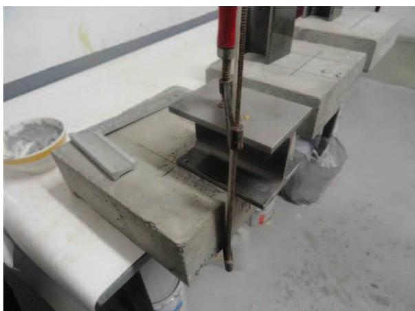
(c) Procédé de serrage des éprouvettes push-out
