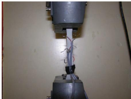
(b) Montage de l'essai de traction réalisé sur éprouvettes haltère
