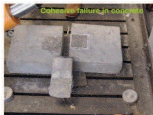
Figure 8.3 – Rupture cohésive dans le béton, d'après (Si Larbi et al., 2007)
