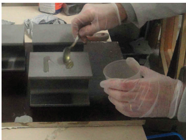
(a) Mise en place du primaire d'adhésion sur la surface de collage du profilé HEB
