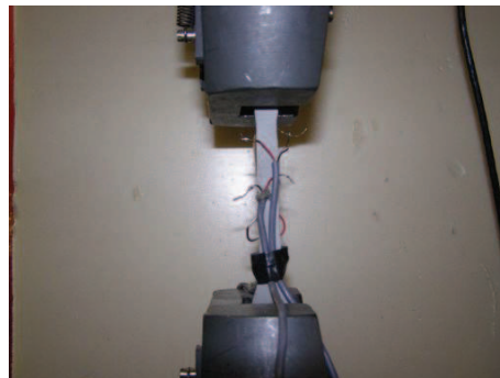
(b) Montage de l'essai de traction réalisé sur échantillons haltère
