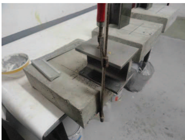
(c) Procédé de serrage des éprouvettes push-out
