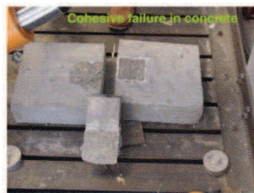
Figure 8.3 – Rupture cohésive dans le béton, d'après (Si Larbi et al., 2007)
