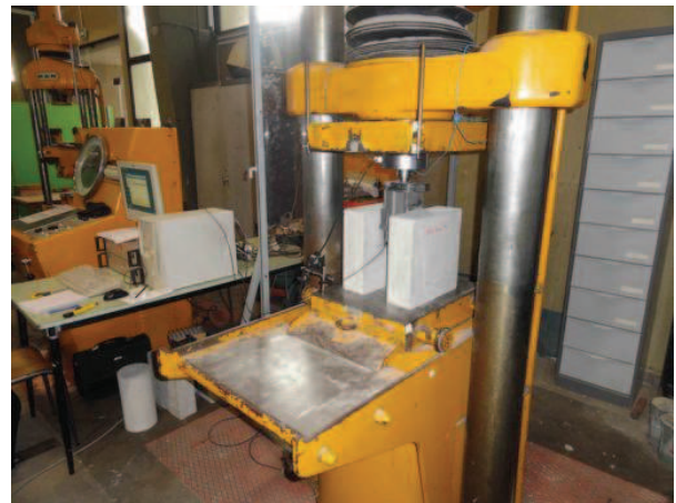
(b) Presse utilisée pour les corps d'épreuve PO2 et PO3
