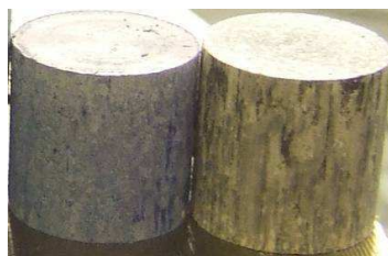
Figure 16 : Échantillons de I1 (à gauche) et de X1 (à droite) photographiés après un essai de frottement (diamètre et hauteur de 10 mm).
