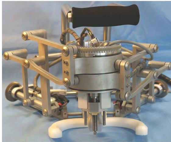
Figure 2.24 – Robot Prosit2, conçu avec la démarche séquentielle
