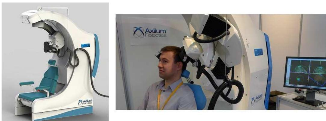
**Figure 1.7** – Robot de stimulation magnétique transcrânienne [AxilumRobotics]
