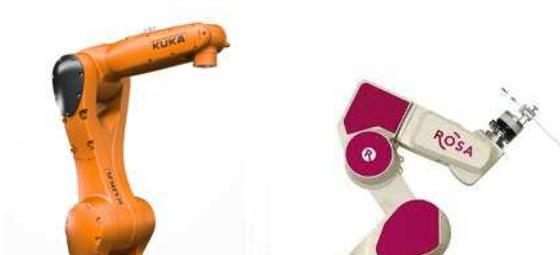
**Figure 1.1** – Robot industriel Kuka de type anthropomorphe et robot de neurochirurgie ROSA de l'entreprise MedTech
