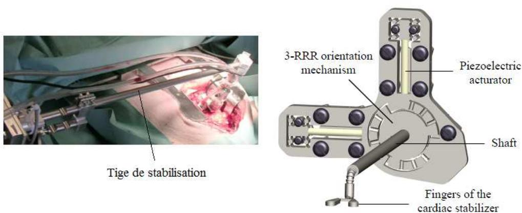
**Figure 1.11** – A gauche, vue du dispositif expérimental de stabilisation active [Bachta, 2008] et à droite vue CAO du dernier stabilisateur cardiaque conçu au laboratoire ICube de Strasbourg [Rubbert *et al.*, 2013]
