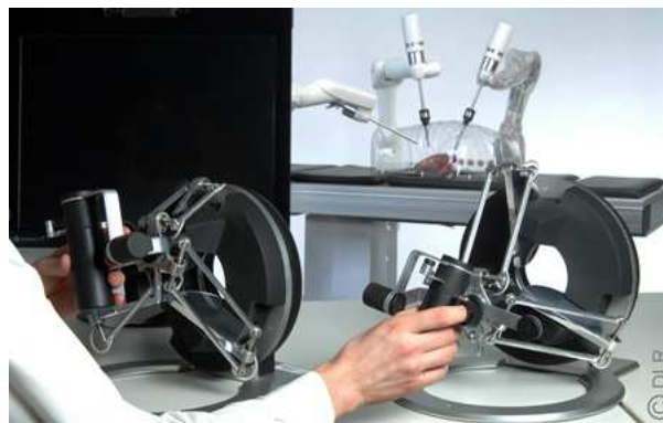
Figure 1.9 – Robot de chirurgie mini-invasive MiroSurge développé par le DLR [DLRMiroSurge]
