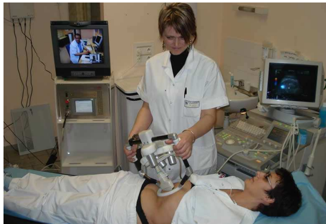
Figure 2.8 – Exemple d'utilisation d'un robot de télé-échographie portable
