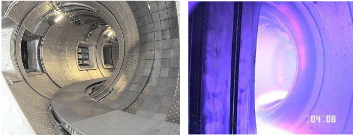
FIGURE 1.2 – A gauche : Photo de l'intérieur de TORE SUPRA (à l'arrêt). Le limiteur est le "trottoir" en bas de la photo. A droite : Image prise par une caméra CCD (dans le visible) de TORE SUPRA en fonctionnement. Un fort dégagement de lumière est généré au niveau du limiteur. Source des deux images : IRFM [2]
