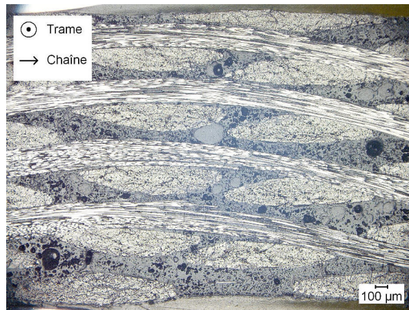
FIGURE 5.8 – Observations au microscope optique de la microstructure de la plaque P12 (coupe A-A), réalisée par RTM - 1 bar, avec une résine non diluée et une préforme 3D
