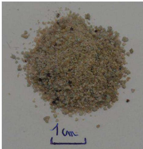
Figure II-1 : Laitier granulé de haut fourneau (Origine Ecocem Moerdijk).
