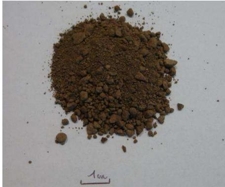
Figure II-4 : Laitier de convertisseur brut (origine ArcelorMittal à Gent)
