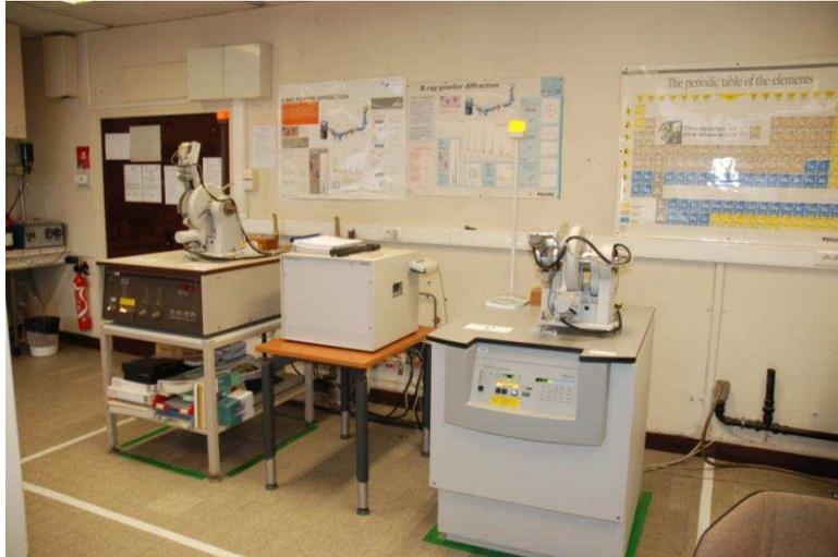
Figure II-20 : Vue d'ensemble des installations de diffraction des rayons X
