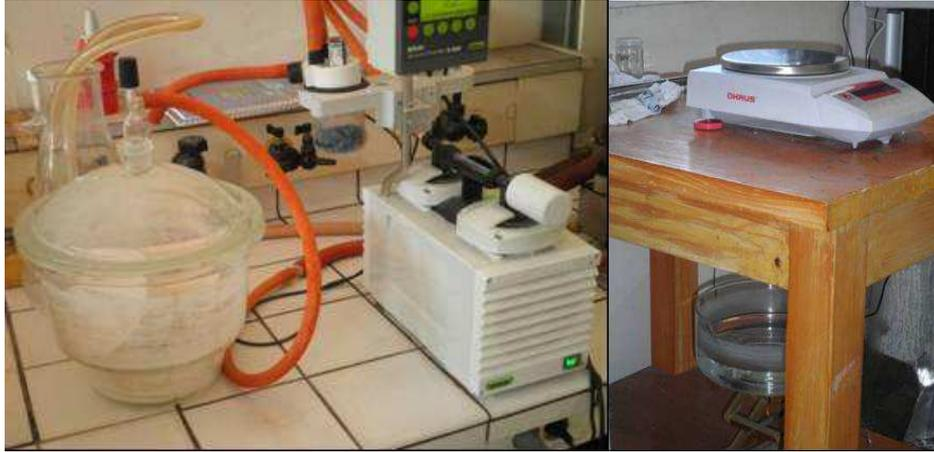
**Figure II-14 : Système pour la mesure de la porosité à l'eau (imprégnation d'eau et balance pour pesée hydrostatique)**
