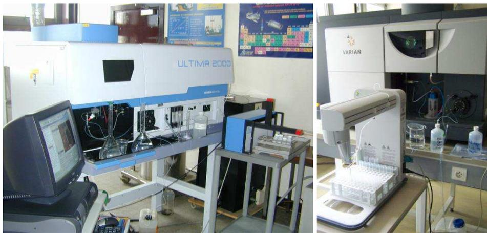
**Figure II-18 : Appareil ICP-AES ULTIMA 2000 et ICP/OES VARIAN 720-ES**
