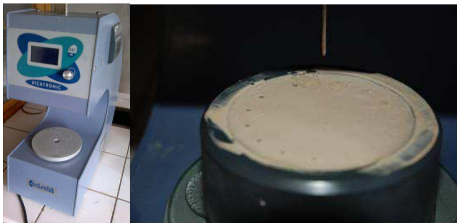
Figure II-15: Appareil Vicatronic pour la mesure de prise Vicat et échantillon en cours d'essai
