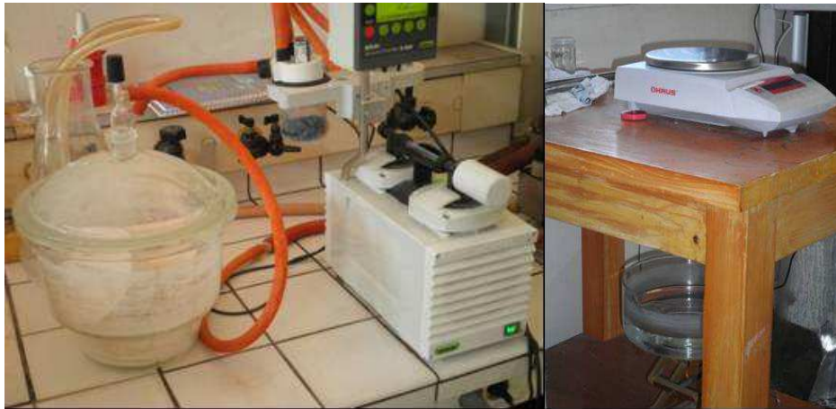
Figure II-14 : Système pour la mesure de la porosité à l'eau (imprégnation d'eau et balance pour pesée hydrostatique)
