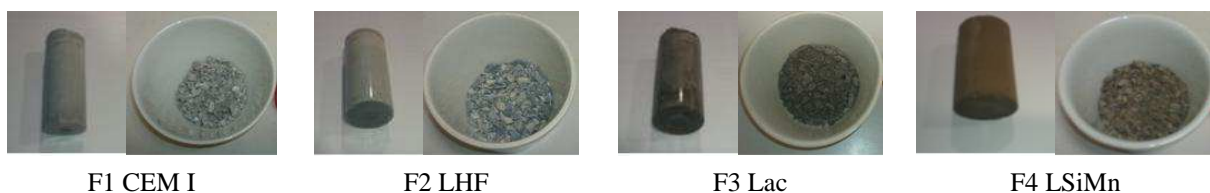
Figure VII-2 : Eprouvettes de pâte de ciment sous forme monolithique (hauteur : 7 cm, diamètre : 3 cm) et concassée (<4mm)
