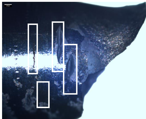
Figure 111 : Micrographie optique de l'éprouvette de T91 testée à 673 K et \dot{\epsilon} \approx 6,7.10^{-5} \text{ s}^{-1} (les fissures sont encadrées en blanc)
