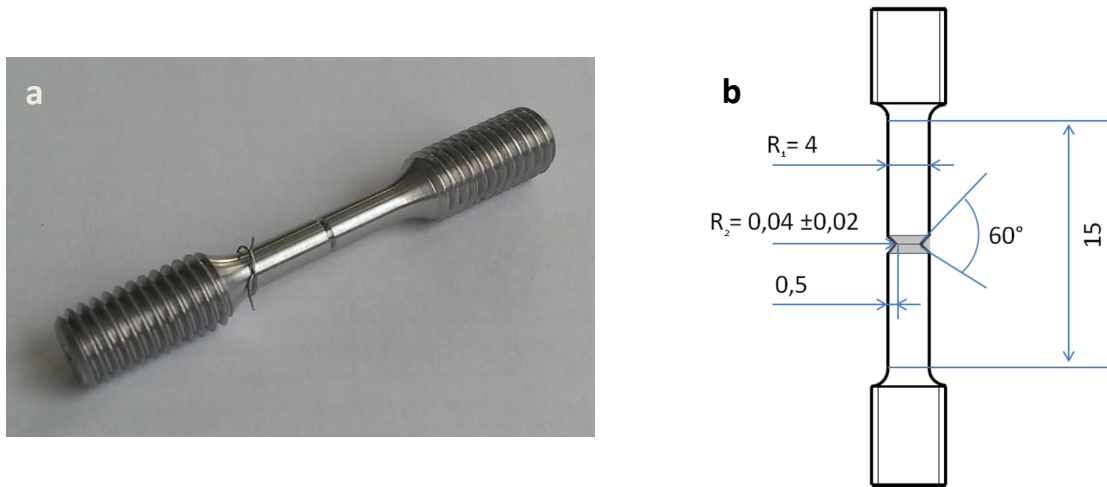
Figure 67 : a) Photographie d'une éprouvette, b) schéma d'une éprouvette avec les dimensions de la zone utile en millimètres
