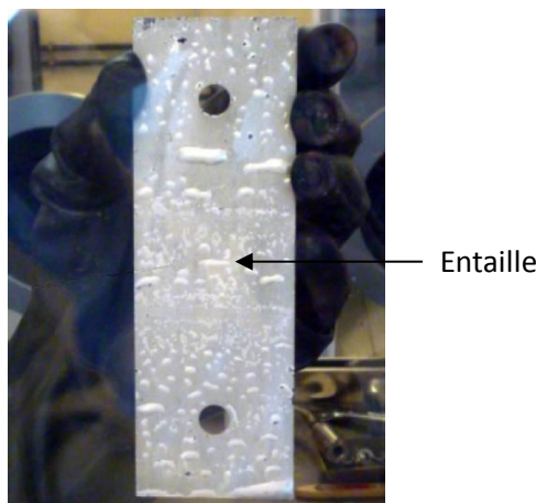
Figure 115 : Eprouvette CCT après exposition au sodium liquide à basse teneur en oxygène
