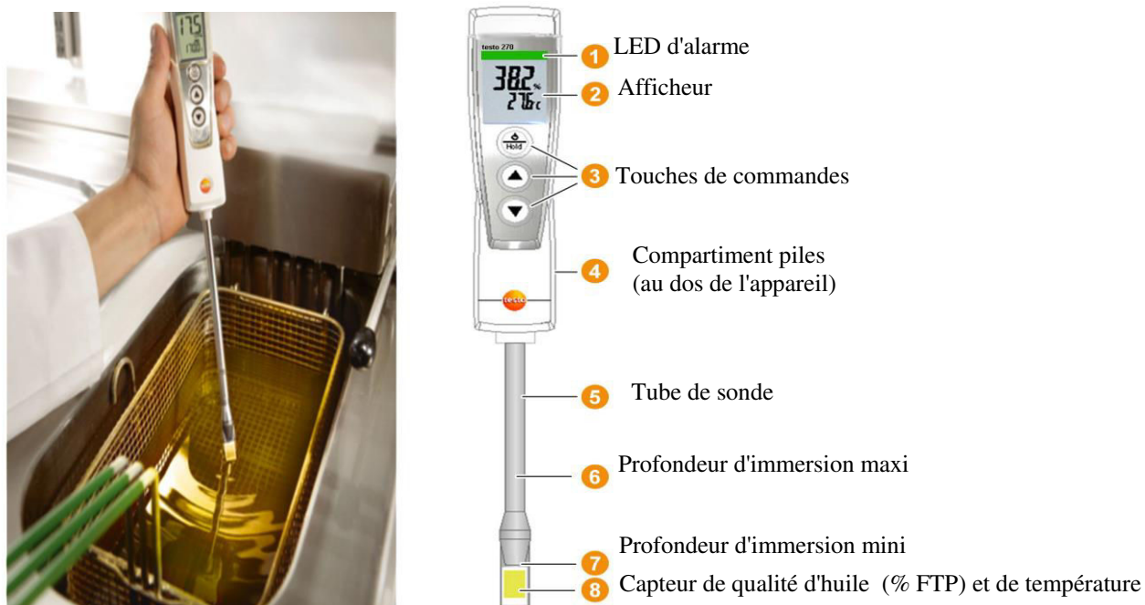
Figure II.7: Image et représentation schématique d'une sonde Testo
