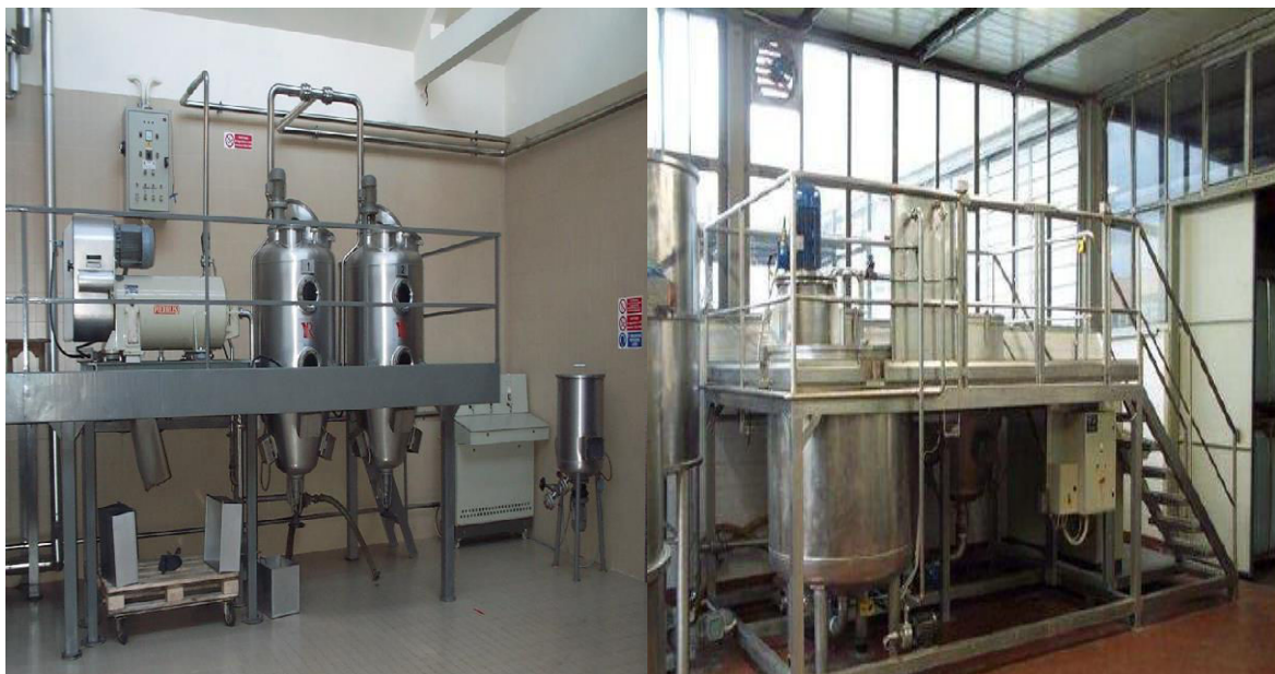
Figure I.8 : Dispositifs d'extraction par ultrasons (2 X 500 L), l'échelle industrielle pour produits liquides et solides permettant l'extraction semi continue (Reus- www.etsreus.com )
