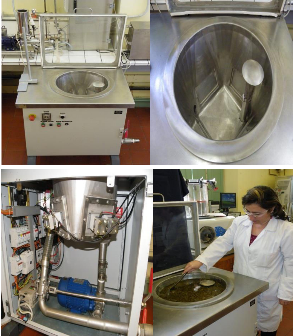
Figure II.19: Equipement ultrasonique (30 L) à l'échelle pilote, utilisé pour l'enrichissement assisté par ultrasons de l'HOV.
