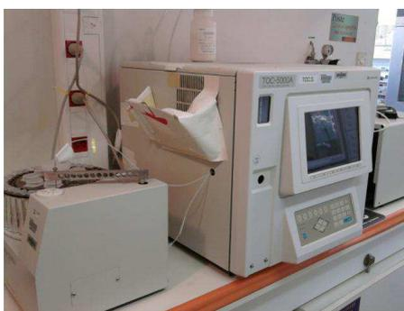
Figure 49 : COTmètre SHIMADZU® TOC 5000-A du laboratoire de biogéochimie, biodisponibilité et transfert des radionucléides (L2BT) de l'IRSN.
