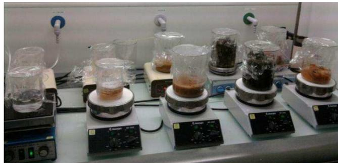
Figure 52 : Aspect général des béchers en fin d'échange labile. Les échanges réalisés dans l'eau de forage sont au premier plan, ceux réalisés dans les « conditions stomacales » sont à l'arrière-plan. De gauche à droite : blanc, pomme de terre, cèdre, feuilles de chêne, pomme.
