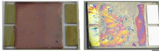
FIGURE 6.1 – Photographies de cellules tandems fonctionnelle (gauche) et dont le dépôt de la CA supérieure a attaqué les couches inférieures (droite).
