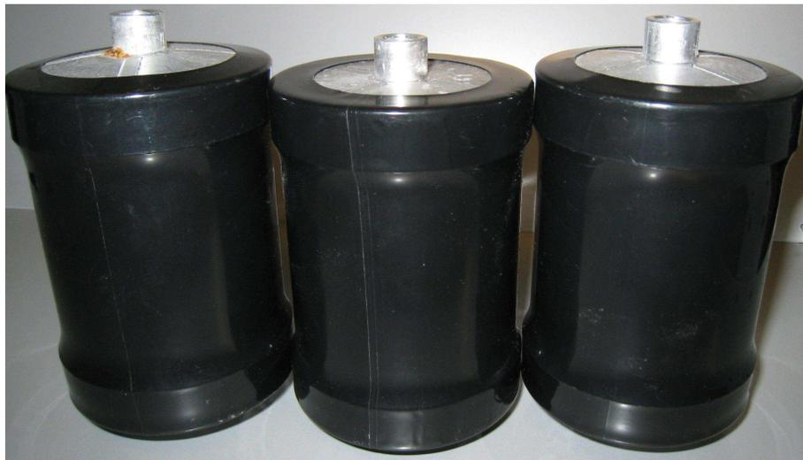
**Figure 3.28 Déformation des éléments SC au cours du vieillissement**
