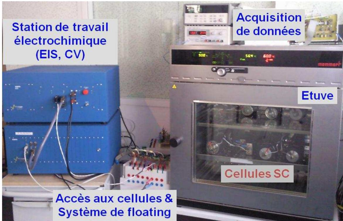
Figure 3.2 Banc de vieillissement calendaire pour supercondensateurs
