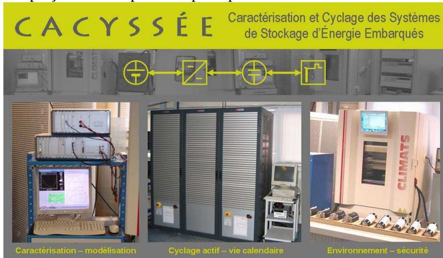
Figure 2.1 Plateforme expérimentale (CACYSSÉE - IMS)
