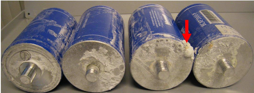
Figure 3.21 Fuite d'électrolyte suite au vieillissement des cellules C 2000F
