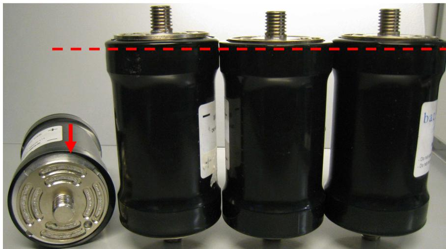
**Figure 3.23 Déformation des cellules de type E après vieillissement**
