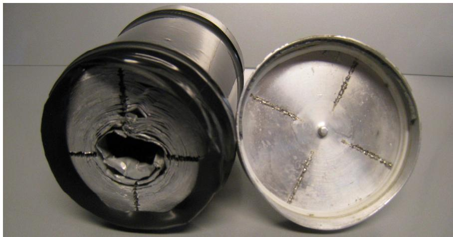
Figure 3.25 Photo de l'élément D24 après défaillance
