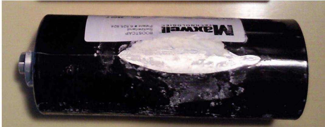
Figure 3.9 Fuite d'électrolyte de la cellule A22 en fin de vie
