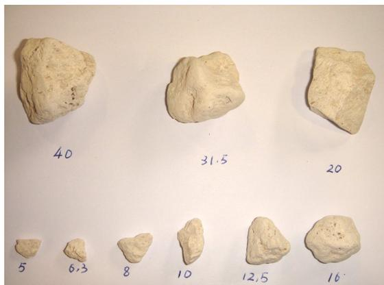
Figure 81. Angularité des granulats calcaires (Hu, 2009)
