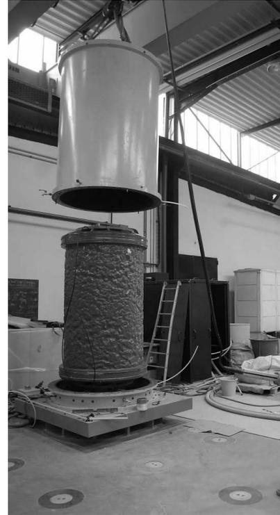
$h=1500\text{mm}$  ;  $\phi=1000\text{mm}$ ;  $\sigma_{c-max}=1,0\text{MPa}$
