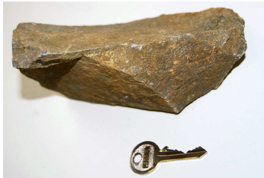
Figure 110. Grains de l'engrochement de Schiste quartzitique de Trois Vallées, fraction de taille 80-100mm
