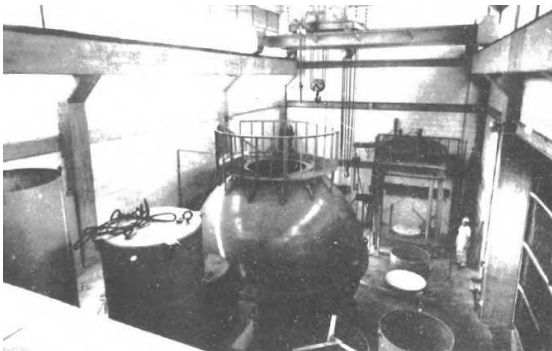
h=2500\text{mm} ; \phi=1130\text{mm} ; \sigma_{c-max}=2,5\text{MPa} (c) Lab. El Infiernillo (Marsal et al., 1965)
