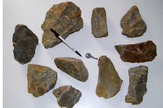
Figure 110. Grains de l'engrochement de Schiste quartzitique de Trois Vallées, fraction de taille 80-100mm
