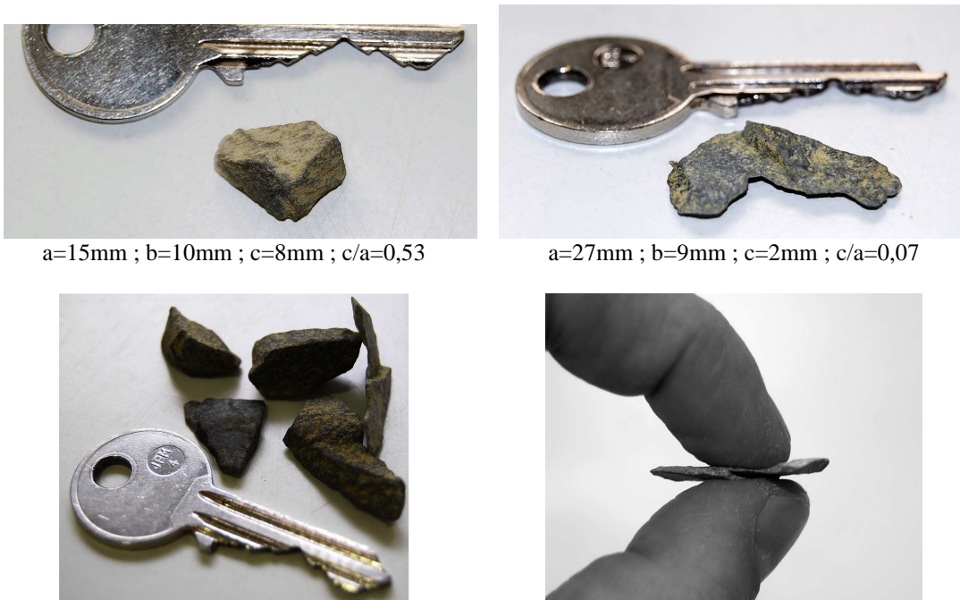
Figure 112. Grains de l'engrochement de Schiste quartzitique de Trois Vallées, fraction de taille 8-10mm
