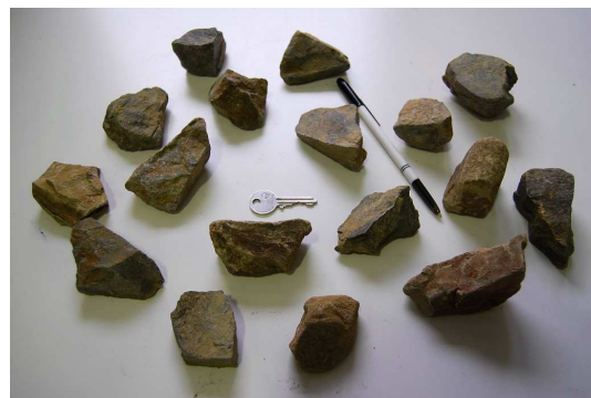
Figure 111. Grains de l'engrochement de Schiste quartzitique de Trois Vallées, fraction de taille 31,5-40mm
