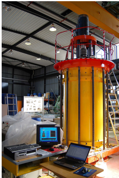
Figure 104. Photographie de la cellule triaxiale pour les échantillons de 1000 mm pendant l'essai
