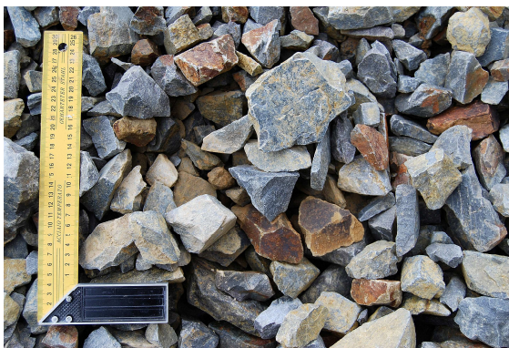
Figure 82. Enrochement de schiste de la carrière des Trois Vallées
