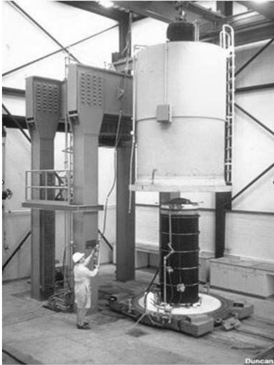
h=2286\text{mm} ; \phi=915\text{mm} ; \sigma_{c-max}=5,0\text{MPa} (a) U. de Californie (Marachi et al., 1969)
