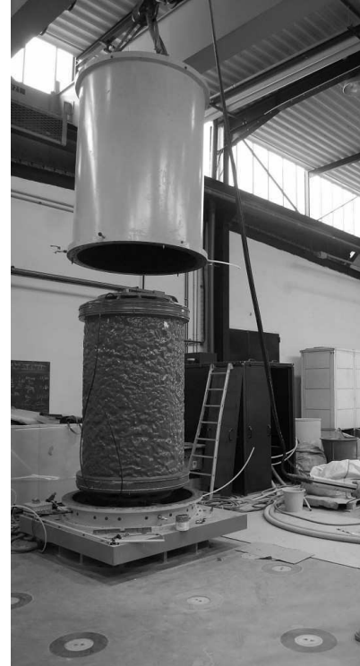
h=1500\text{mm} ; \phi=1000\text{mm} ; \sigma_{c-max}=1,0\text{MPa} (b) Ecole Centrale Nantes
