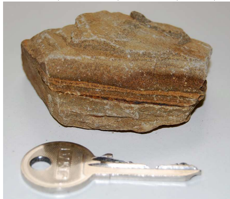
Figure 111. Grains de l'engrochement de Schiste quartzitique de Trois Vallées, fraction de taille 31,5-40mm
