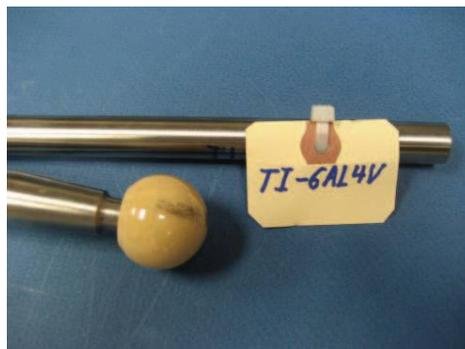
Figure 64 : transfert de particules métalliques sur la tête céramique
