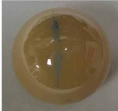
**Figure 63 : Stripe wear sur la tête céramique, colorée au bleu de méthylène**
