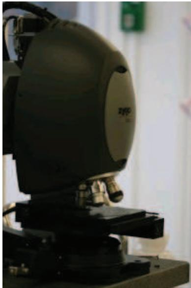
Figure 69 : microscope interférométrique Zygo 6300
