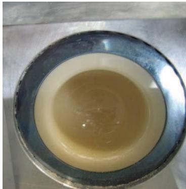
**Figure 65 : Edge wear sur l'insert céramique**
