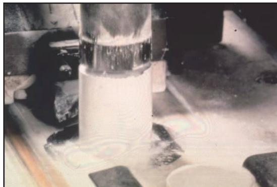
Figure 20 : Compressage de la poudre d'alumine. (Photos CeramTec)
