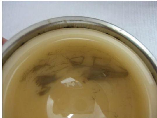
Figure 72 : Transfert métallique sur l'insert céramique
