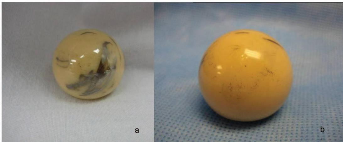
Figure 71 : transfert métallique (a) et stripe wear (b) sur les têtes céramiques
