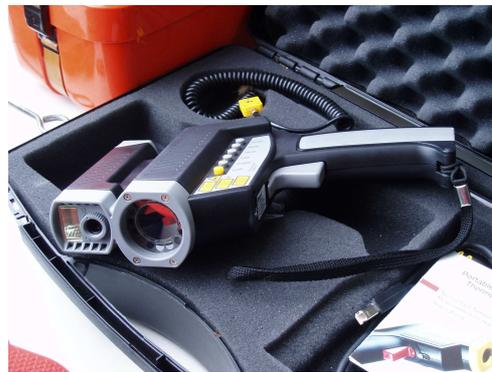
Figure 34 radiothermomètre utilisé lors de la campagne de mesure.
