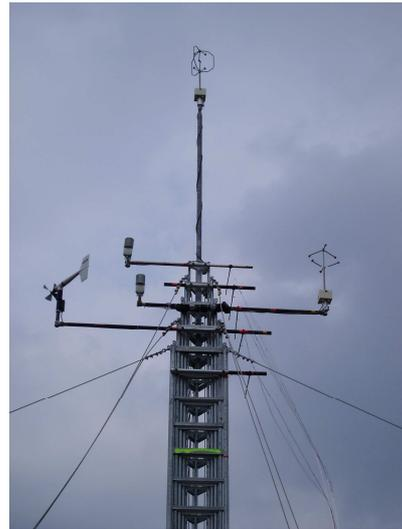
**Figure 201** Mât du site PEN en position verticale mais non déployé. on distingue les anémomètres, les capteurs THR et les réseaux de câbles des thermocouple.
