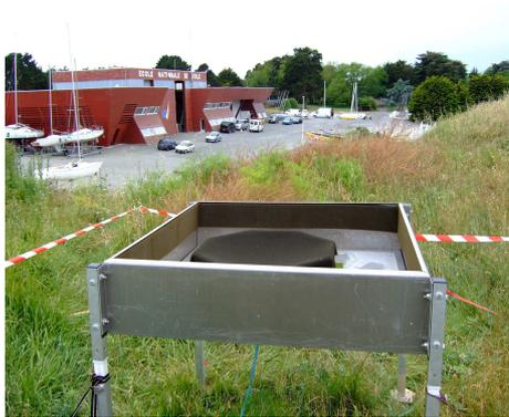
**Figure 25** Vue du sodar avec en arrière plan, le hangar de l'ENV où était située notre salle de travail.
