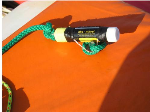
**Figure 33 Capteur de température à immerger NKE**
