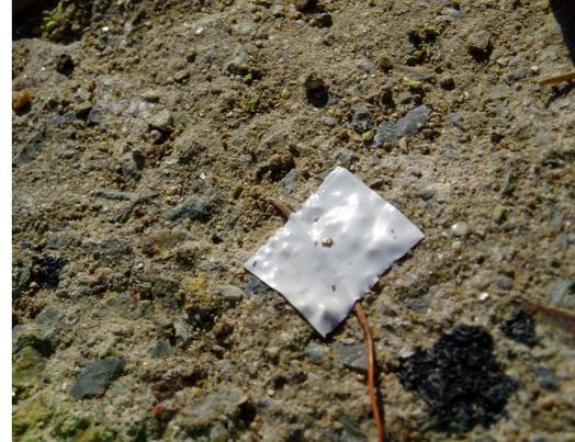
**Figure 30** Thermocouple 5 posé sur un sol nu.
