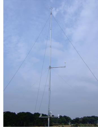
Figure 31 Site STP vu depuis la mer (on aperçoit le mât au sommet de la butte) (gauche); Mât pneumatique équipé des capteurs sur le site STP (droite).
