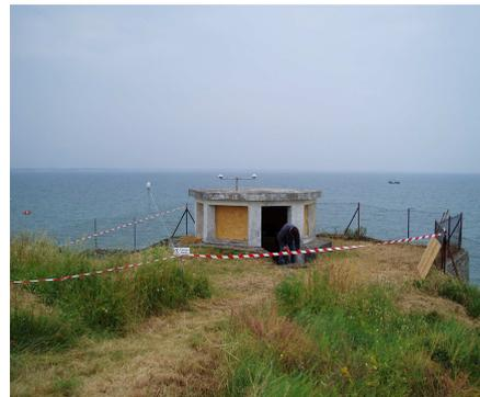
**Figure 26** Vue de la "vigie". Le pyranomètre et le pyrgeomètre sont placés sur le toit. A gauche est placé le capteur THR.
