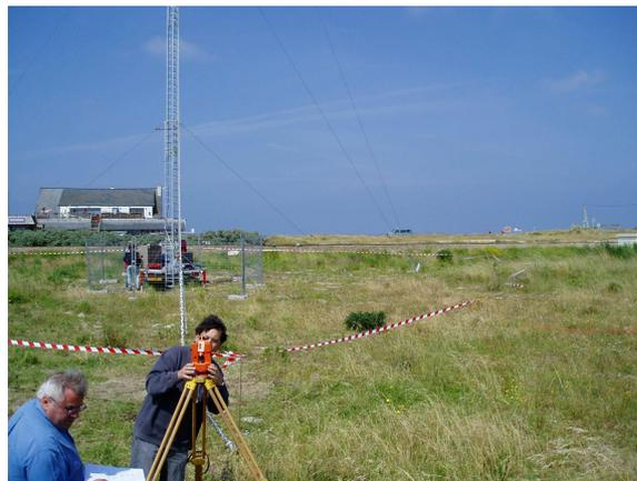
**Figure 202** Mesures au théodolite de la hauteur des capteurs sur le site PEN (en arrière-plan le bâtiment de la biscuiterie).
