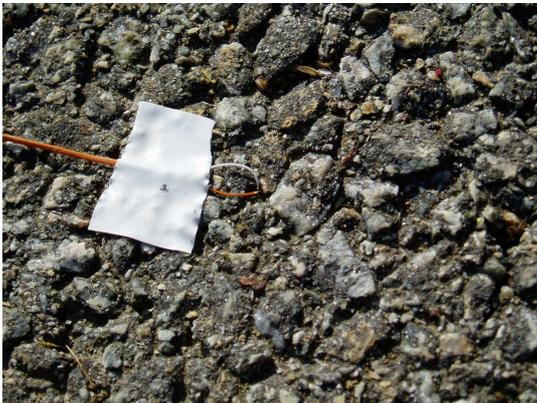
**Figure 29** Thermocouple 4 posé sur le bitume.
