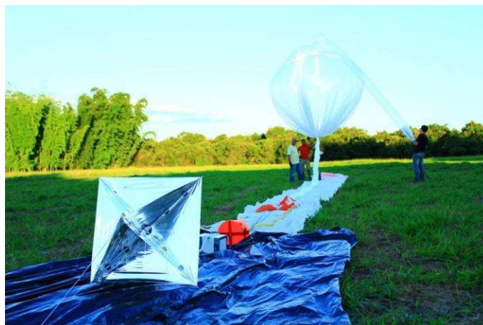
Figure 96. Gonflage du ballon. La chaîne de vol, prête à être lâchée, est étendue sur le tapis de sol
