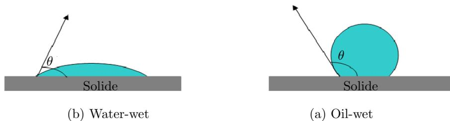
**Figure I.2** – Caractérisation de la mouillabilité.
