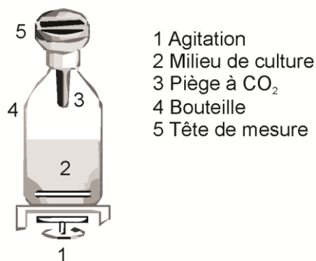
Figure II-16 : Représentation schématique d'un respiromètre utilisé pour évaluer la vitesse de respiration.
