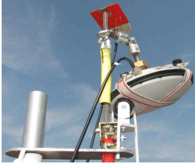
FIGURE 5.3 – Antennes réceptrices au sommet du mât
