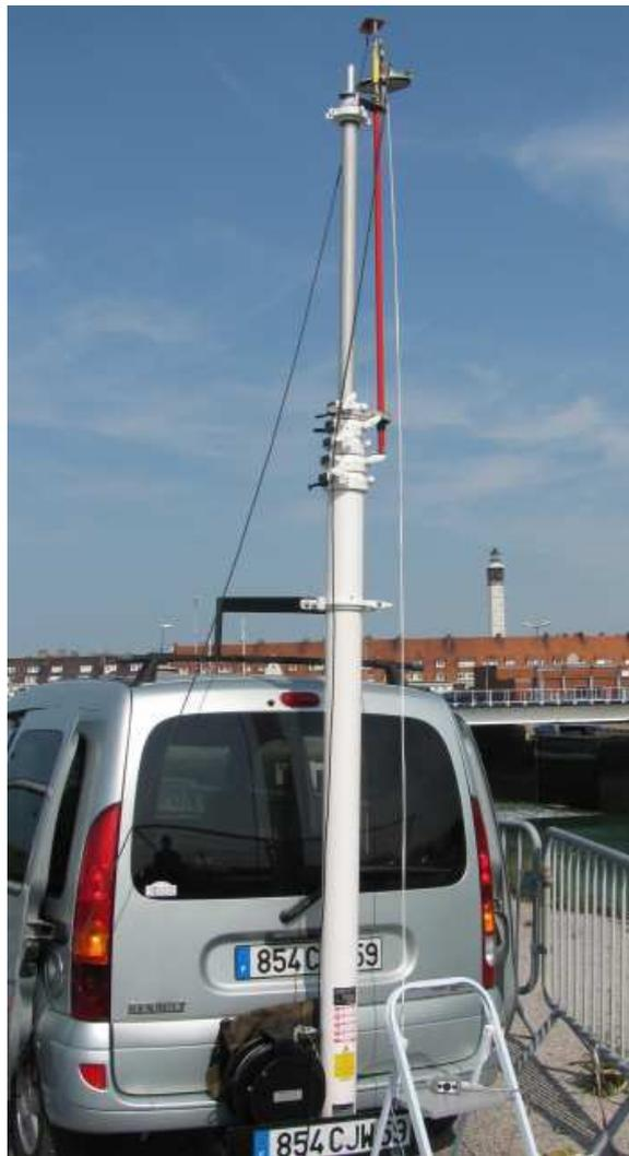
FIGURE 5.2 – Système altimétrique embarqué sur la voiture instrumentée
