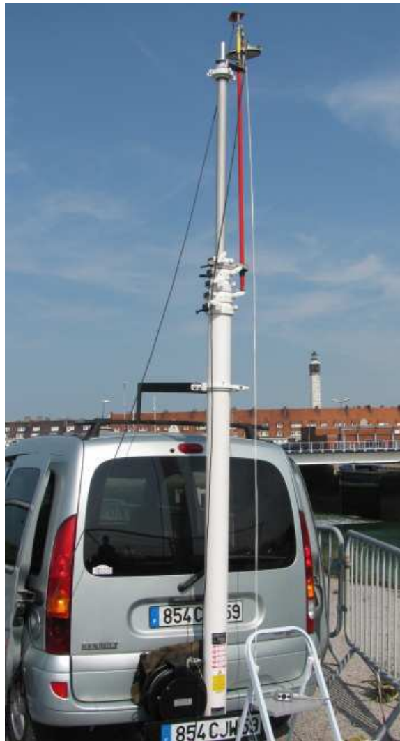
FIGURE 5.2 – Système altimétrique embarqué sur la voiture instrumentée
