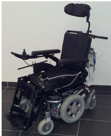
**FIGURE 1** – Fauteuil 6-roues de série robotisé
