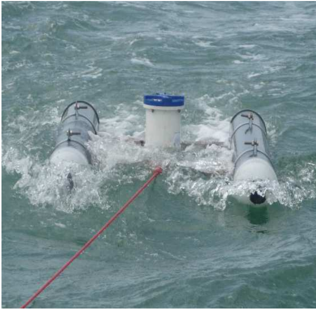
Fig. 2.13 photo de l' ADCP tracté avec le système Kursk déployé en rade de Boulogne sur le mer le 27 et 28 mars 2012.
