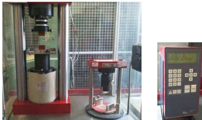
Figure II-10 : (a) Presses à mortier (pour flexion à droite et pour compression à gauche). (b) moniteur de commande
