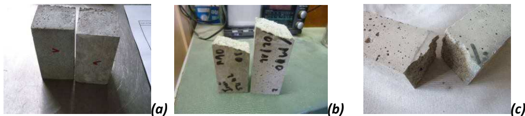
Figure V-12 : Différents modes de rupture. (a) Adhésive. (b) Cohésive dans le support. (c) Cohésive dans le support.
