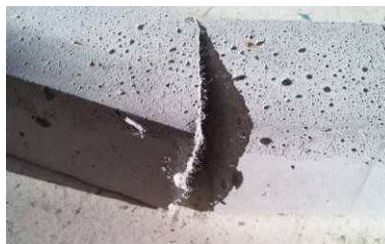
Figure III-21 : Eprouvette du produit M6 après une flexion 3 points
