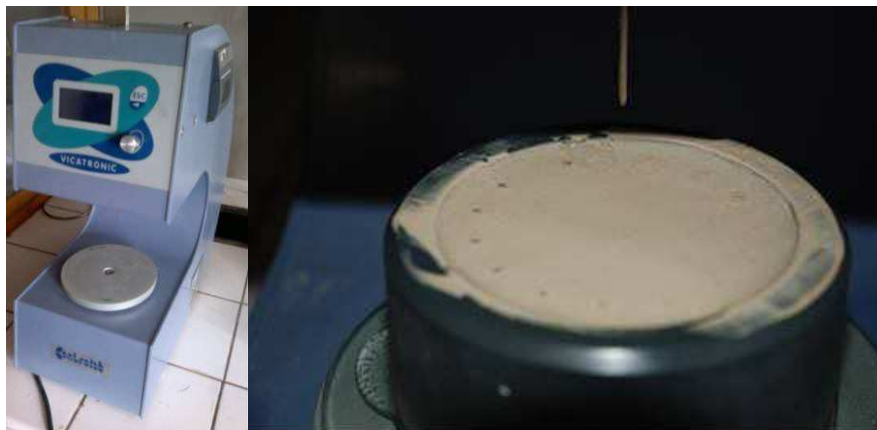
Figure II-7: Appareil Vicatronic pour la mesure de prise Vicat et échantillon en cours d'essai
