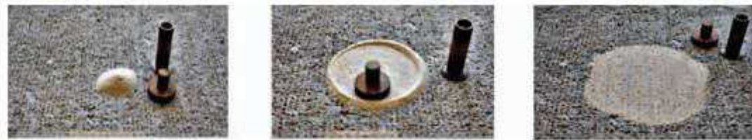
Figure I-33 : Méthode de la tâche de sable pour évaluer la macrotexture d'une surface [Courard 2012]
