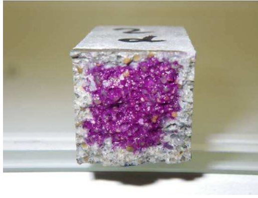
Figure II-12 : Epreuve imprégnée de phénolphtaléine pour la mesure la profondeur de carbonatation
