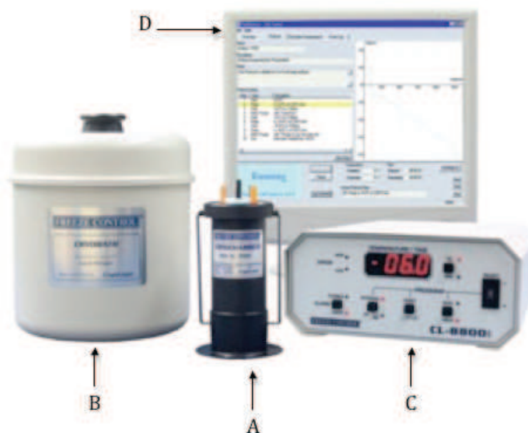
Figure 39 Congélateur programmable : (A) chambre de congélation ; (B) cuve à azote liquide ; (C) programmeur ; (D) relais informatique
