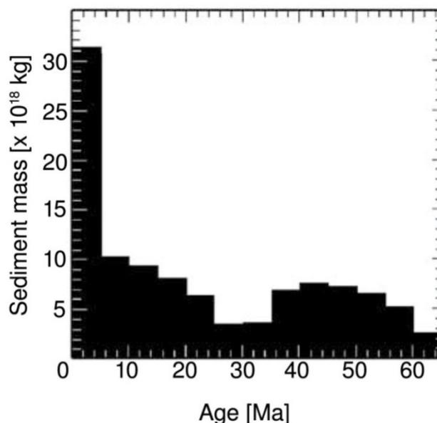
Figure 9.1 : Mesure de la masse globale de sédiments accumulés dans les océans (d'après Hay et al., 1988; Molnar, 2004; Schumer et Jerolmack, 2009). Cette accumulation est mesurée sur des intervalles de 5 Ma. Ces données suggèrent une accélération brutale de la sédimentation océanique depuis 5 Ma.
