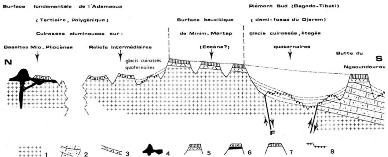
Figure 4.12: Interprétation des étapes de cuirassement dans l'Adamaoua (Fritsch, 1978). (1) socle indifférencié, (2) grès continentaux (Crétacé moyen), (3) vieux basaltes altérés de la Surface de Minim-Martap, (4) basaltes mio-pliocènes de la surface fondamentale, (5) cuirasse bauxitique de Minim-Martap, (6) cuirasse alumineuse sur basalte mio-pliocène, (7) cuirasse alumineuse sur Relief Intermédiaire, (8) glaciis et cuirasses.
