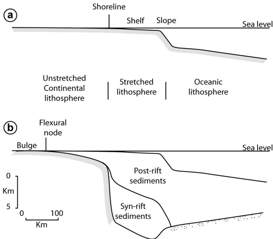
Figure 1.8 : Schéma illustrant la réponse flexurale de la lithosphère par formation d'un bourrelet marginal (bulge) associé à une charge sédimentaire au niveau de la transition continent-océan dans un contexte de marge passive (Watts, 1982).
