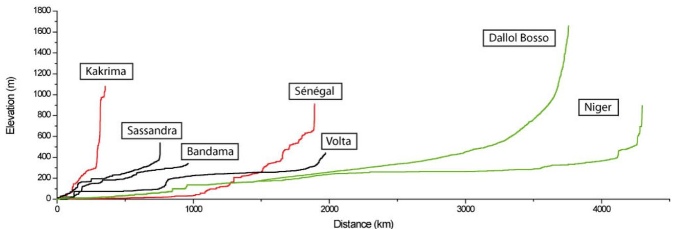
Figure 2.18 : Profils en long des principaux fleuves d'Afrique de l'Ouest (voir Figure 2.15 pour localisation). Ces profils montrent de nombreuses irrégularités, notamment des knickzones, où les rivières changent rapidement de pente.
