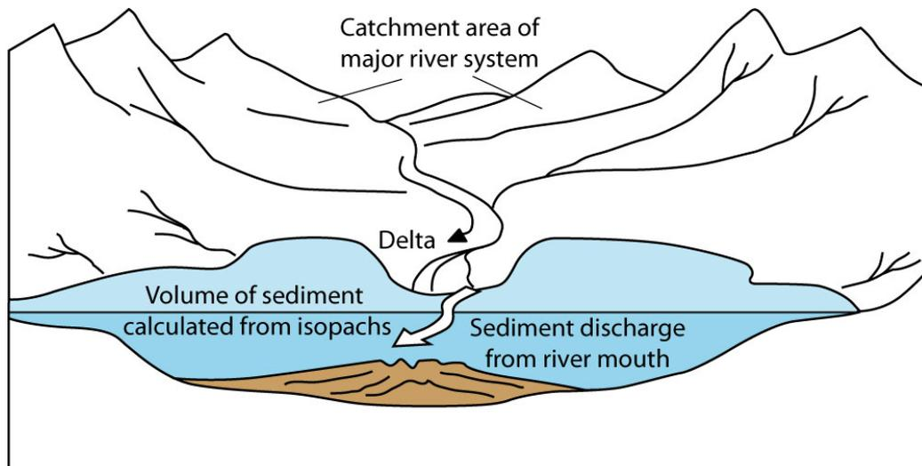
Figure 1.5 : Schéma d'acheminement des sédiments terrigènes (« sediment routing system »). Les rivières transportent jusqu'aux bassins les particules érodées dans leur bassin-versant sur le continent. Une estimation des volumes érodés est faite à partir de mesures de taux de dénudation dans les bassins-versants, de charge solide et dissoute dans les rivières ou de calculs des volumes à partir des épaisseurs des bassins sédimentaires (Allen et Allen, 2005).
