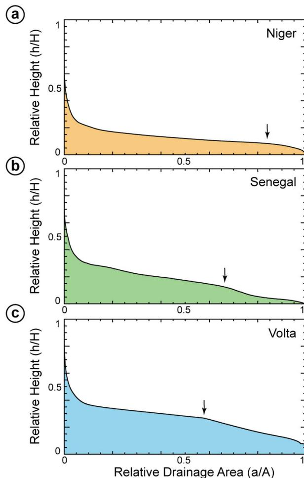
Figure 2.17 : Courbes hypsométriques (pourcentages relatifs cumulés des altitudes en fonction de l'aire drainée relative) pour les trois principaux bassins-versants d'Afrique de l'Ouest ( $h/H$  : hauteur divisée par hauteur maximale ;  $a/A$  aire divisée par aire totale). Les flèches indiquent les points d'inflexion en aval des courbes hypsométriques.
