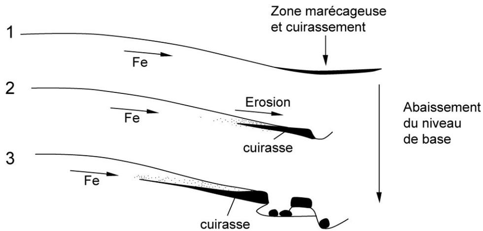
Figure 3.8 : Schéma d'accumulation des sesquioxides et de cuirassement en réponse à l'abaissement du niveau de base donnant lieu, à terme, au démantèlement de la cuirasse (Maignien, 1959).
