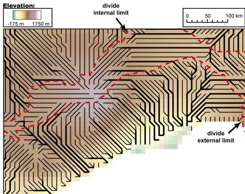
Figure 9.6: Exemple local de positionnement des limites de la ligne de partage des eaux formé par le bourrelet marginal de la topographie S1 en fonction de la géométrie des drains extraits. Les rivières extraites sont en noir. Localisation en Figure 9.5a.
