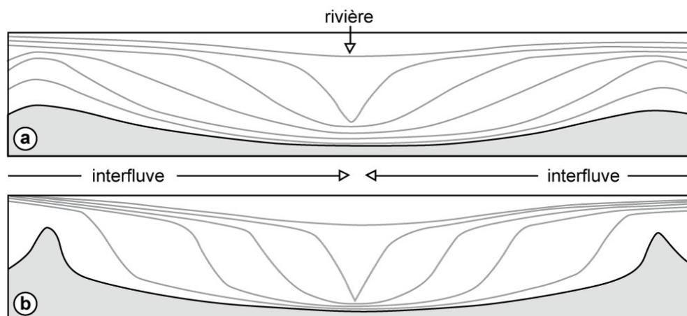
Figure 1.3 : Schémas possibles d'évolution des interfluves (Duff et al., 1993): (a) modèle d'abaissement progressif des interfluves par diffusion (Davis, 1899) et (b) modèle de formation de pédiment par recul d'escarpement sans changement d'angle (Penck, 1953).
