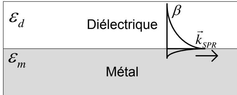
Figure 2.13 Représentation de l'onde évanescente SPR à l'interface métal/diélectrique
