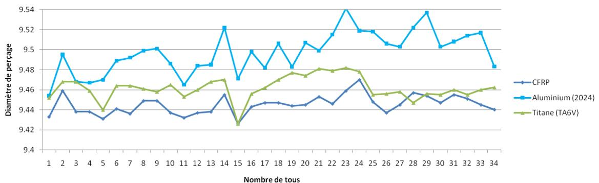
Figure 53 – Evolution de diamètre dans un empilage CFRP/Aluminium/Titane
