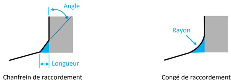
Figure 50 – Types de préparation de bec
