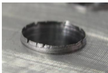
Figure 5 – Exemple de bavure formée à la débouchure d'une couche d'aluminium
