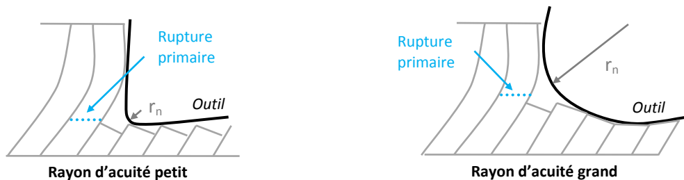
Figure 43 - Influence du rayon d'acuité pour une orientation à 135° par rapport à la vitesse de coupe
