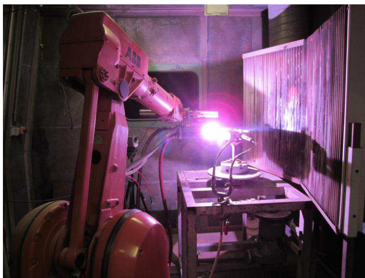
Figure II.3. Photo d'installation de projection plasma atmosphérique.
